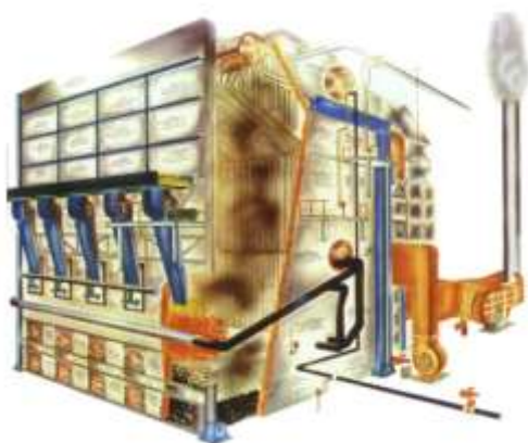
Figura 1.14: Representação de uma caldeira
